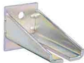
In Stahl galvanisch verzinkter Wandwinkel, Ausführung für drei Laufschiene, zu verwenden mit höhenverstellbaren Muffen Typ .B04. Zusätzliche Einbaumaße ab Seite 91.
