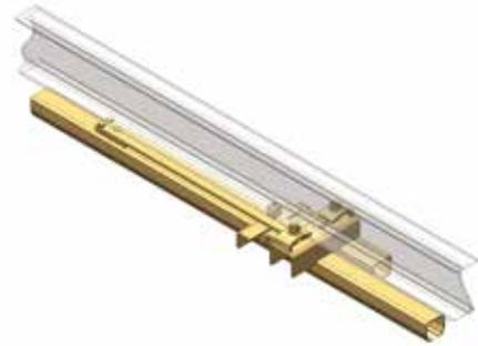
Mit angeschweißter Aufhängeplatte und I-Träger Klemmplatten, zur Abstützung der Weiche vom Hauptträger der Systemtragkonstruktion
