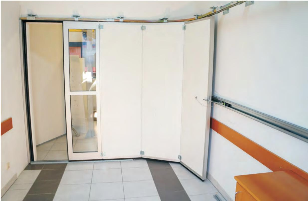
Seitensektionstor mit Doppelaufschiene mit platzsparendem seitlichem Einlauf.
